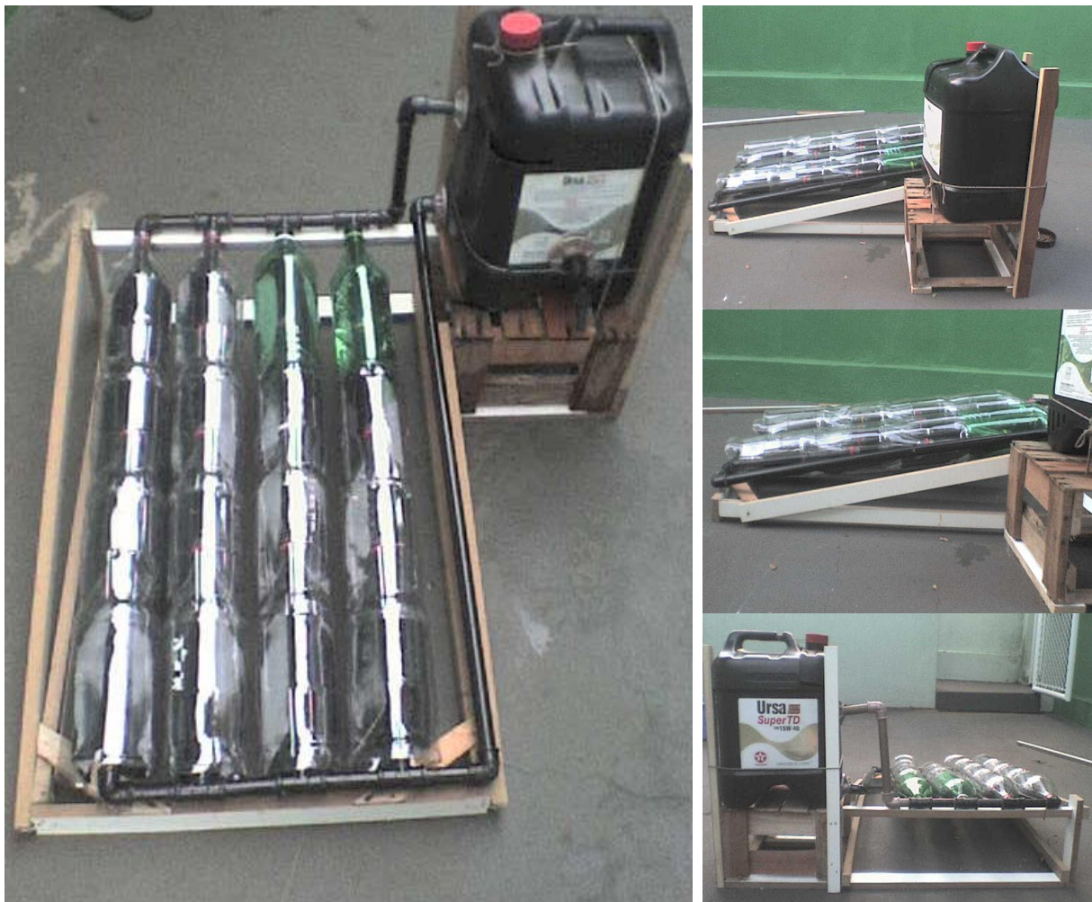
Figura 1. Maquete do aquecedor solar construído com materiais recicláveis.
